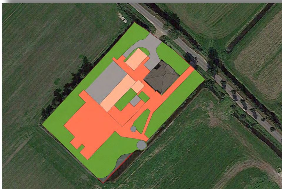
Te amoveren bebouwing en verharding
